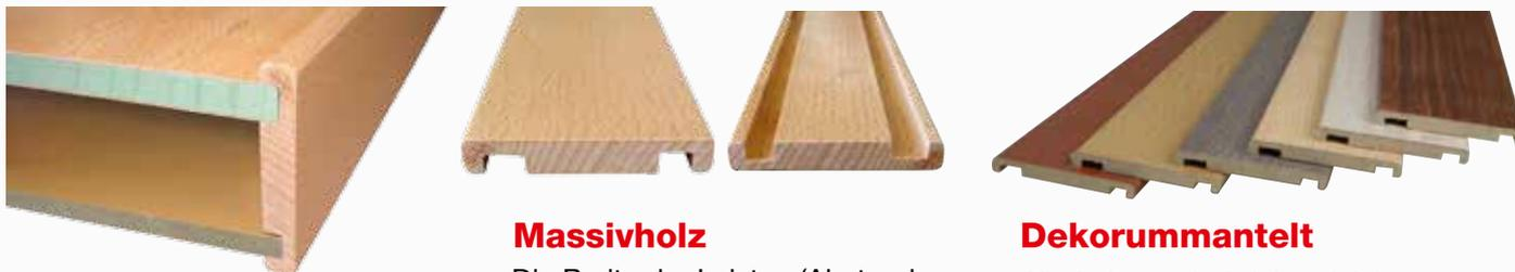
Abdeckleisten zur rückseitigen Stufenverkleidung bei offenen Treppen. Die breite Nut (11 mm) dient zur Aufnahme der Trittstufe, die schmale (8 mm) zum Einschub der Unterverkleidungsplatte.
